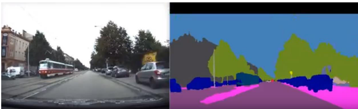
Obrázek 43: Segmentace obrazu dopravní situace před vozidlem
