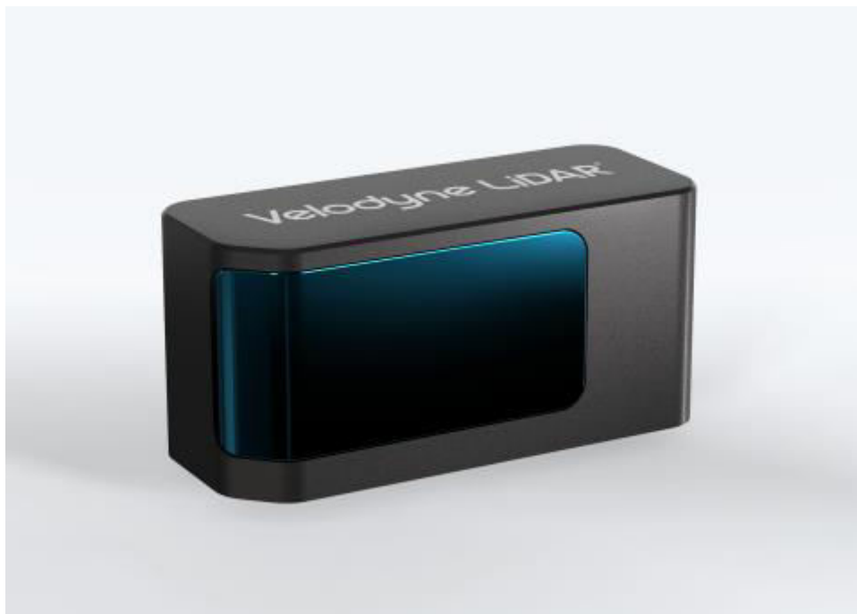
Obrázek 39: Solid State Lidar od firmy Velodyne (Velarray)
