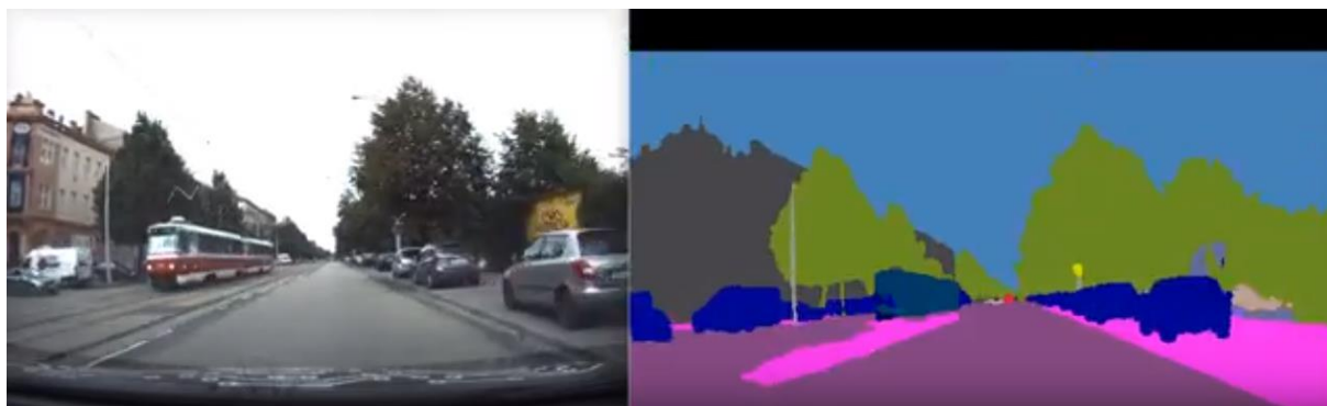
Obrázek 45 : Segmentace obrazu dopravní situace před vozidlem – zdroj [RoboautoSeg]
