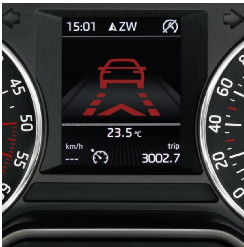
Obrázek 4: Grafické rozhraní systému nouzového autonomního brzdění od Škody Auto. https://i.ytimg.com/vi/Sy2GCqI3IDc/maxresdefault.jpg
