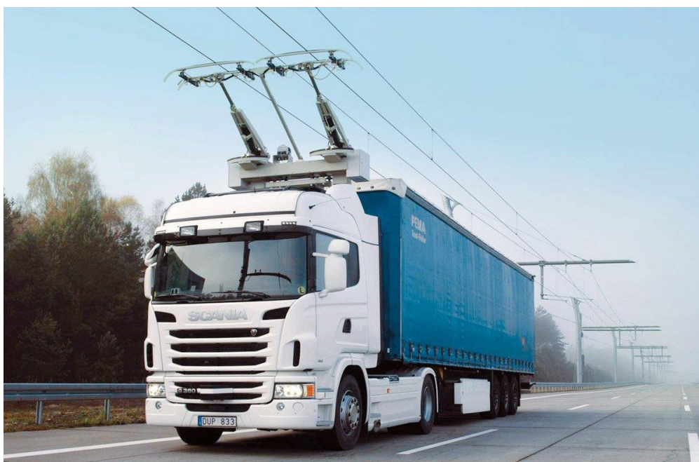
Obrázek 5: eHighway – nákladní vůz s odběrem elektřiny sběrači na střeše.
