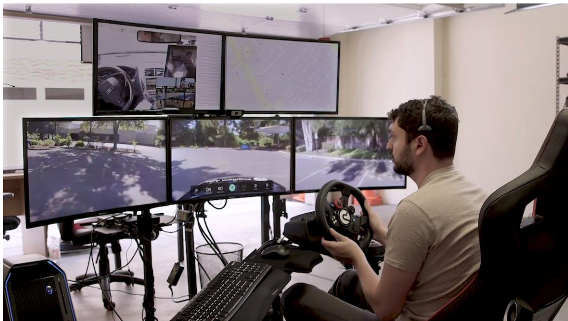
Obrázek 3 : Pracoviště vzdáleného ovládání vozidla (zdroj: phantom.auto)
