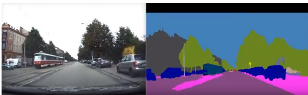
Obrázek 12 : Segmentace obrazu dopravní situace před vozidlem – zdroj [RoboautoSeg]
