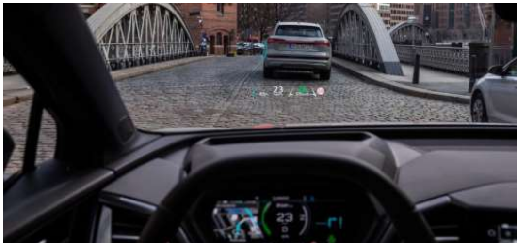
Obrázek 18: Head-up display současného vozu (Audi Q4 e-tron, 2020) s rozšířenou realitou a navigací
