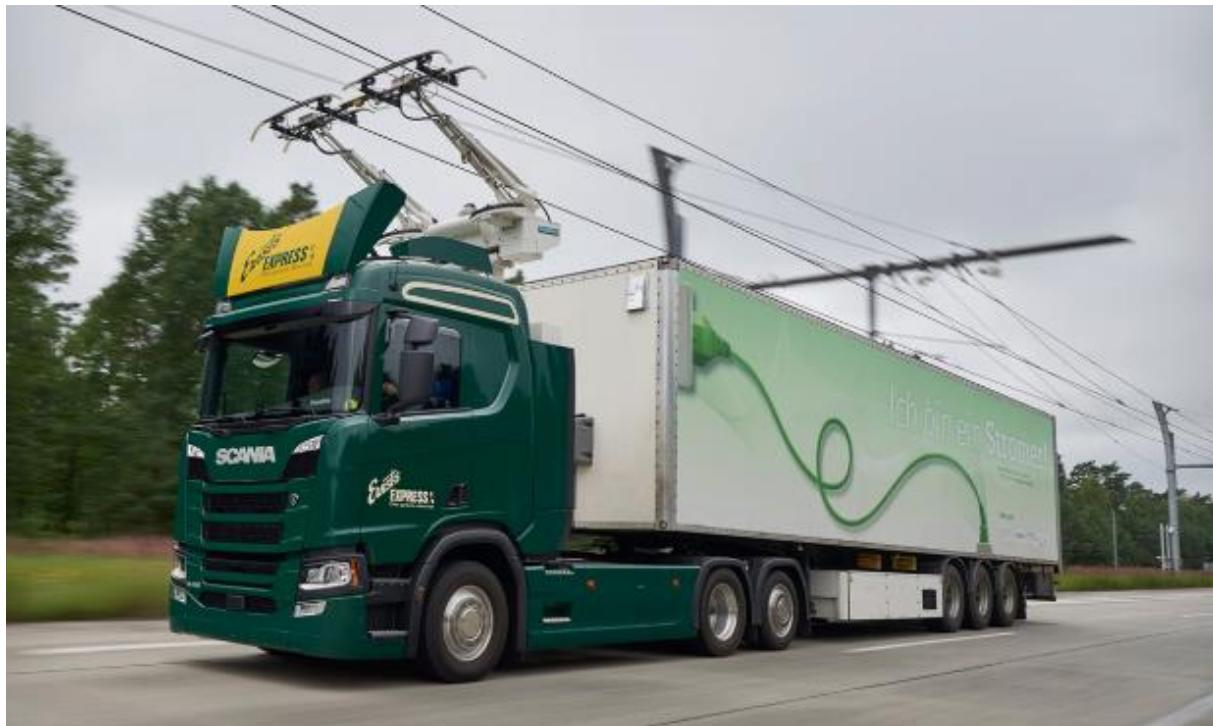
Obrázek 30 Elektrifikovaná dálnice
