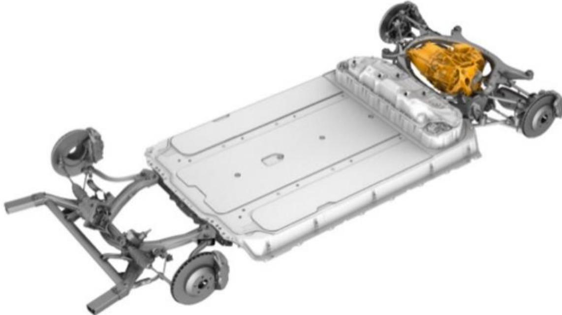
**Obrázek 28 Kompletní pohon elektromobilu Tesla 3**
