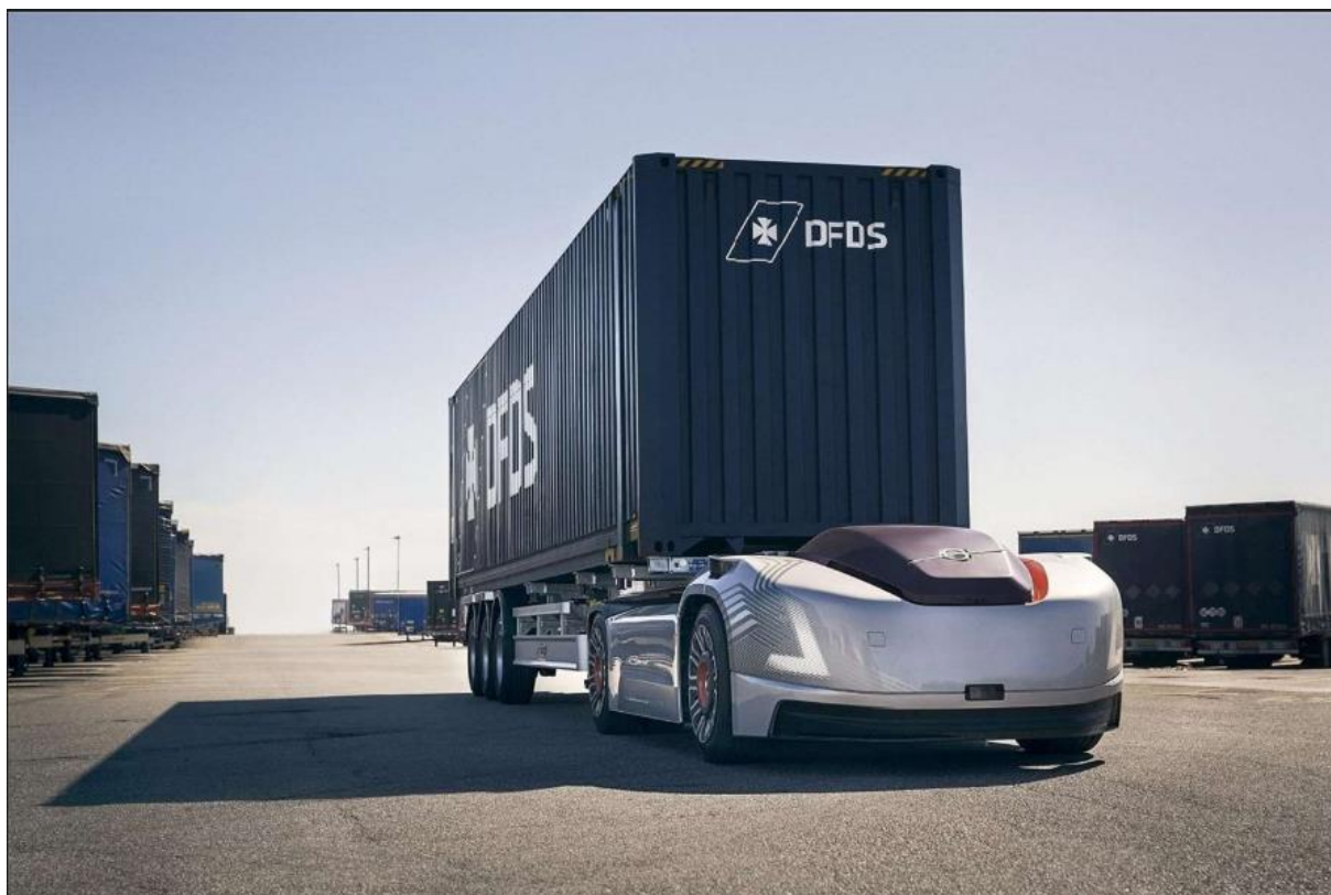
Obrázek 8 : Autonomní tahač Volvo Vera v přístavu v Göteborgu (zdroj: Volvo Vera)
