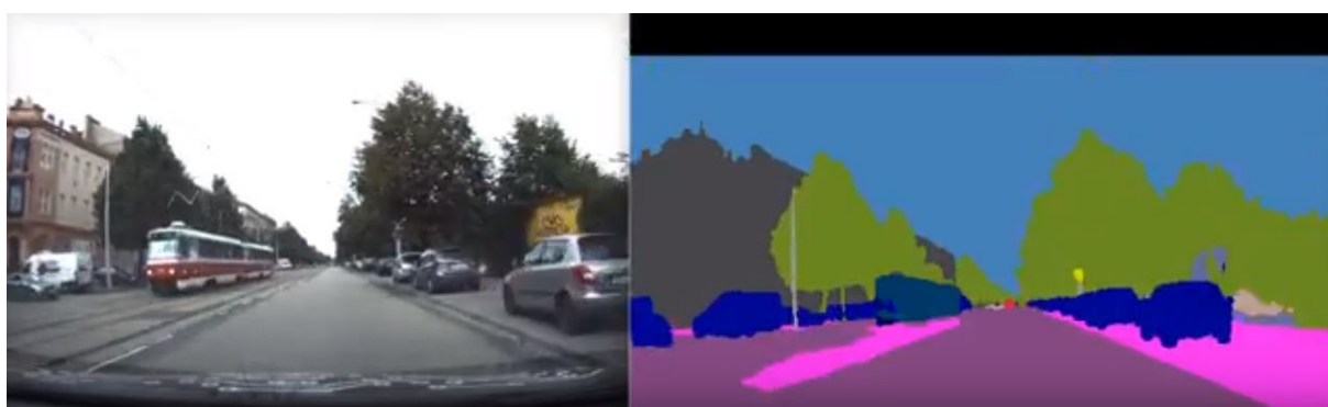
Obrázek 14 : Segmentace obrazu dopravní situace před vozidlem – zdroj [RoboautoSeg]
