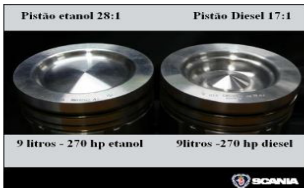
Obrázek 12 Porovnání pístů pro kompresní poměr 28:1(etanol) a 17:1 pro motorovou naftu 21
